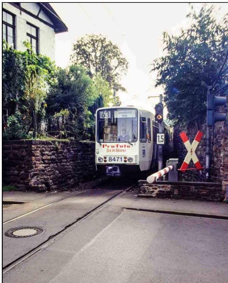
Links: Wagen „8471“ hat soeben die Endhaltestelle Rheinallee verlassen und ist als Linie 63 auf dem Weg nach Tannenbusch. Den Übergang sichert eine automatische Schrankenanlage mit Straßensignalen.
