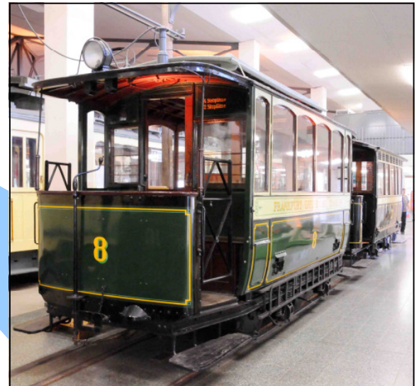
Triebwagen 8 von 1884 (oben rechts). Vom Dach aus führte ein Kabel zur Schlitzrohr-Oberleitung, den Schlitten im Rohr zog der Wagen hinter sich her (oben Mitte und links). ■ Fotos: Harald Flux
