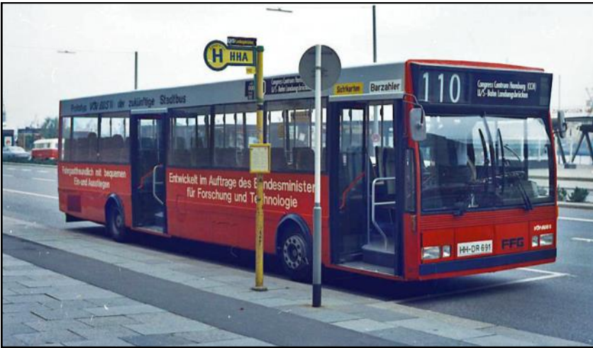
Prototyp „VÖV-Bus II“ des Standard-Linienbusses der zweiten Generation. Das von den FFG Hamburg gebaute Fahrzeug wurde von 1976 bis 1984 in Hamburg eingesetzt und dann von anderen Verkehrsbetrieben erprobt. Gut zu erkennen sind die kleinen 55-Prozent-Niederquerschnittsreifen. Die Aufnahme entstand 1979 an den Landungsbrücken am Hamburger Hafen. ■ Foto: Volker Dibbern
