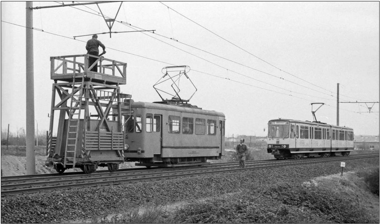
SSB-Arbeitswagen A42 war mit einem Turm-Beiwagen am 26. April 1977 im Arbeitseinsatz auf dem Streckengleis zwischen Villich-Müldorf und Villich. Im Hintergrund ist der SSB-Wagen 7574 als Fahrschule zu sehen. Das gesperrte Gleis bot die Gelegenheit, Personal auf Stadtbahnwagen auszubilden. ■ Foto: Joachim Eckhardt
