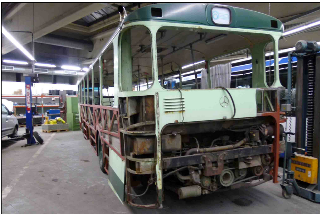
Heckansicht des Vereinsbusses. Deutlich ist zu sehen, wo die Rostschäden entstanden. ■ Foto: Volker Dibbern
