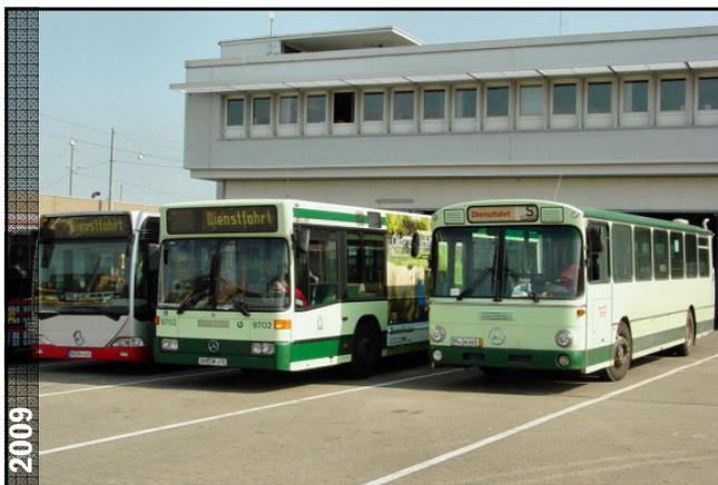
Unser Bus „8603“ wurde am 25.11.1986 zugelassen und stammt aus der letzten Lieferserie der „O 305er“ mit den Wagennummern 8601 bis 8616. Die Wagen hatten die ab 1975 angebotene strömungsgünstigere Front mit einer leicht geneigten Scheibe, die sich optisch gelungener in die Karosserie einpasste.
