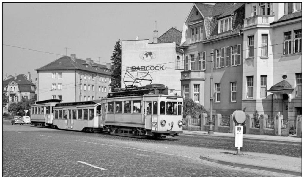
**rechts:** Der 1924 gelieferte Niederflur-Beiwagen 46 erhielt um 1955 eine neue Mitteltür mit einer einteiligen Scheibe.
